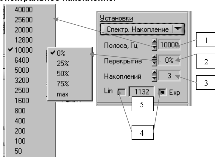
Рис.2.4. Элементы управления поля Установки , обеспечивающие выбор: 1 – полосы анализа, Гц; 2 – процент перекрытия данных; 3 – числа накоплений может быть выбрано в пределах 1 – 131072; 4 – типа накопления Lin - линейное; Exp – экспоненциальное; 5 - индикатор текущего числа накоплений.
