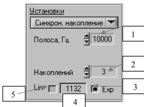
Рис.2.5. Элементы управления поля Установки , обеспечивающие выбор: 1 – полосы анализа, Гц; 2 – числа накоплений может быть выбрано в пределах 1 – 131072; 3,5 – тип накопления Lin - линейный; Exp – экспоненциальный; 4 - индикатор текущего числа накоплений.
